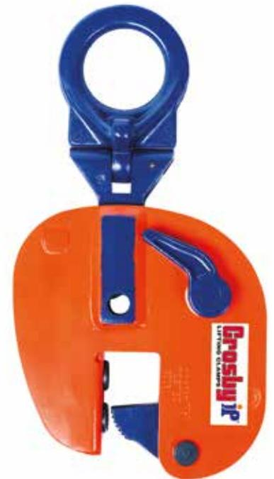
Die Schiffbauklemmen des Typs IPBUZ eignen sich für das senkrechte Heben, Transportieren und Positionieren von Wulstprofilen zum Schiffsrumpf. Diese Klemmen verfügen über eine Verriegelung in geöffneter und geschlossener Stellung, die für höchste Zuverlässigkeit sorgt. Sie eignen sich ausschließlich für Wulstprofile (nicht für Platten).
